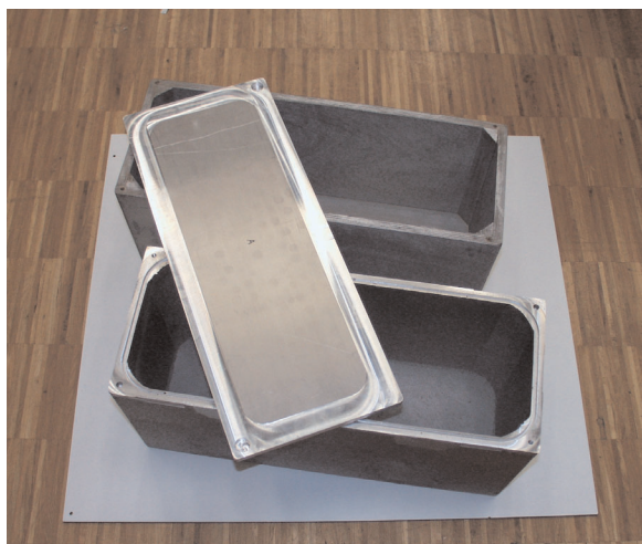
Fig. 2: Aluminum vessel and related wooden model for adding onto a spectrometer (Sichelschmidt). Abb. 2: Aluminiumgefäß und dazugehöriges Holzmodell für den Anbau an ein Spektrometer (Sichelschmidt).
