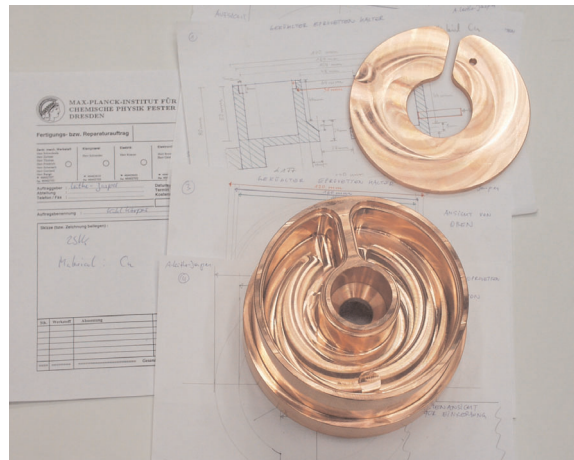
Abb. 3: Kupferwerkstück mit Kühlmittelanschluss. Fig. 3: Copper part with refrigerant connection.
