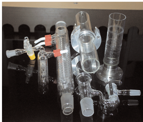
Fig. 4.: Add-on parts for glass apparatuses made by the glass blower. Abb. 4: Vom Glasbläser gebaute Zusatzteile für Glasapparaturen.
